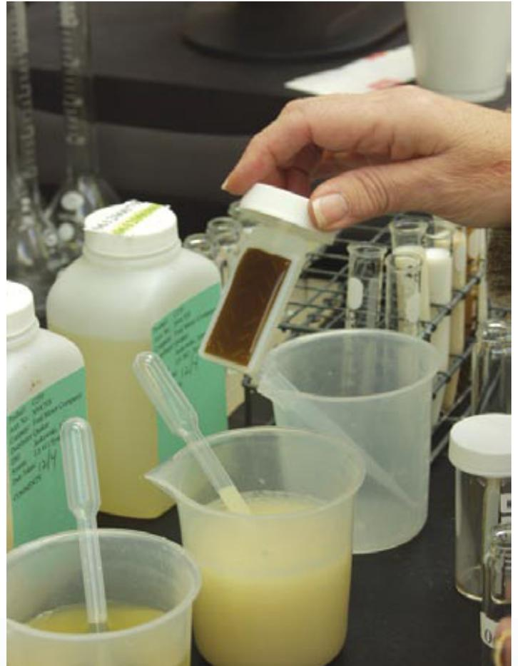
厌气性细菌中的脱硫弧菌、能在几乎所有的水溶性液体中生长、导致强烈的臭鸡蛋气味、含硫化氢、就是“星期一上午臭味”的来源、引起机床和工作表面腐蚀、在有铁元素的情况下、液体的颜色会变黑。
